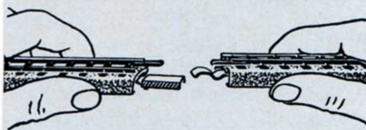
Abb. 10 Anbringen der Mittelleiter- isolierung 5022
