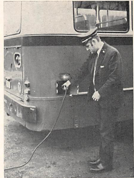
Après avoir retiré la fiche de charge, le conducteur enrôlera et suspendra soigneusement le câble.
