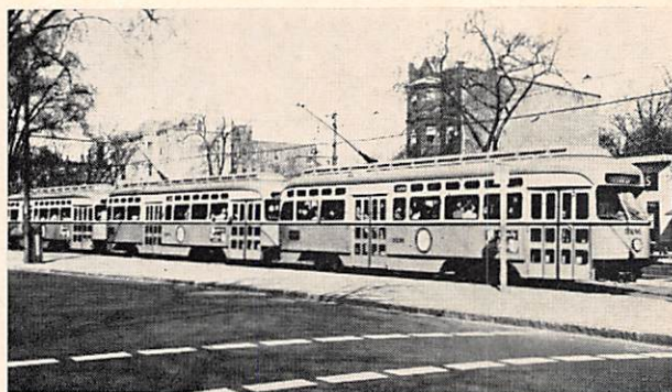
Semi-Métro de Boston : rame de trois motrices P.C.C. circulant sur site spécial avant d'emprunter un tunnel.
