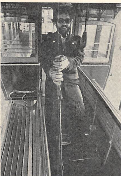
Cet homme tient solidement le levier qui rend le véhicule solidaire du câble en mouvement. C'est le « gripman », il manipule la pince géante qui agrippe le câble. Ce poste de travail est situé entre les banquettes, il s'agit d'un travail fatigant et demandant des efforts répétés.
