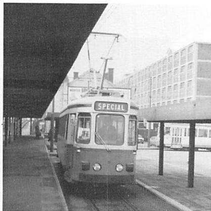
Les motrices S sont, pour ainsi dire, entièrement démantelées. En somme, on n'en garde que le châssis, l'ossature, le toit et les bogies. Tous les appareillages mécaniques, électriques et pneumatiques sont renouvelés ou rajoutés. Elles sont munies de nouveaux équipements et de dispositifs spéciaux, pour rendre les voitures à même de circuler sur la boucle et les antennes de semi-métro.
