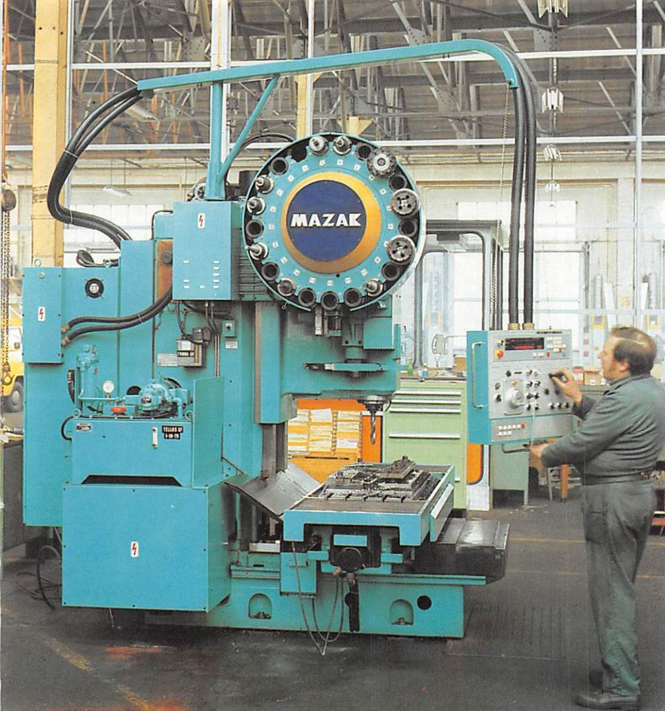
Centre d'usinage à commande CNC (Computer Numerical Controlled) pour forage et fraissage à Destelbergen.
