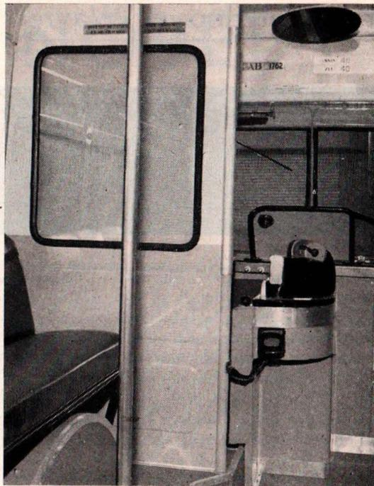
La photo ci-dessus représente le poste de conduite avec la cloison de séparation vitrée derrière laquelle le rideau d'occultation a été tiré. Le conducteur pourra désormais aérer à sa guise le poste de conduite sans imposer un courant d'air aux voyageurs assis derrière lui.
