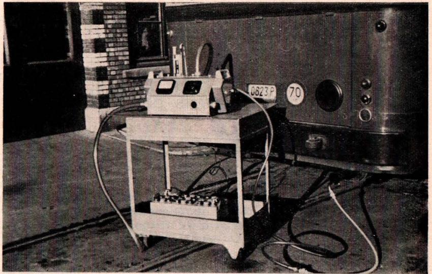
Un tube en plastique est adapté au pot d'échappement. C'est une batterie d'accus, visible dans le bas du chariot, qui donne le courant nécessaire au fonctionnement de l'appareil.
