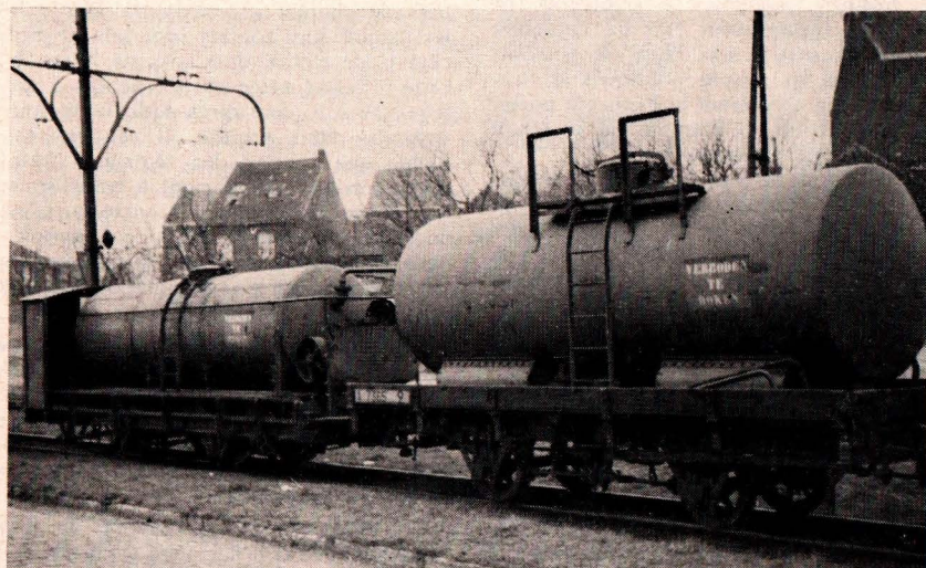
Vue de deux tanks du train désherbeur de Louvain ; au côté droit du premier tank on remarque le dispositif de pompage entraîné par l'essieu du train.
