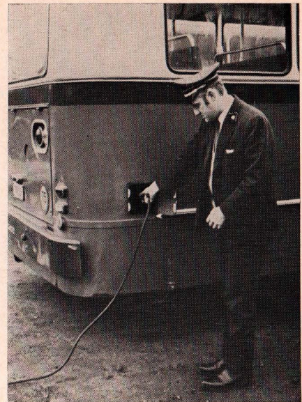
Na de laadkabel te hebben verwijderd, zal de bestuurder de kabel zorgvuldig oprollen en ophangen.
