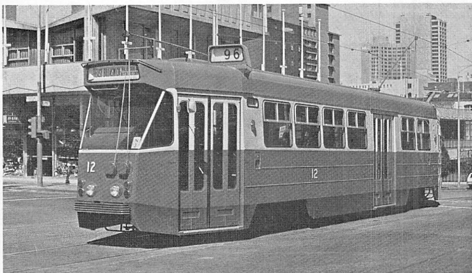
Motrice Z à Melbourne du côté de la porte d'entrée à l'avant Ces voitures sont conçues pour la circulation à gauche (Photo ASEA) A remarquer : le double câble de rattrape-trolley et l'indicateur de numéro de ligne décentré par rapport à l'indicateur de direction.
