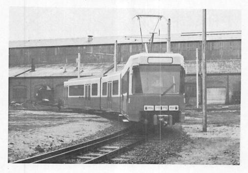
La SNCV qui avait demandé des voitures à deux caisses souhaite que la partie centrale soit démontée. D'autre part, la SNCV aurait demandé un controller muni d'un manipulateur manuel, alors que la BN a équipé le véhicule d'une conduite aux pieds (comme les motrices PCC déjà livrées), celle-ci étant disponible de stock!
