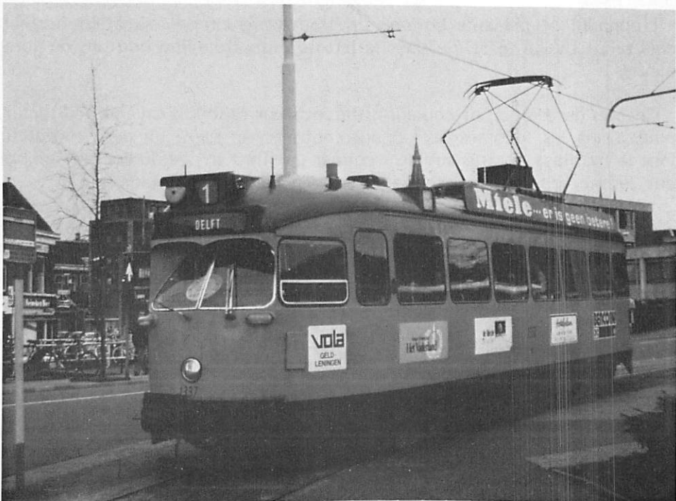
Motrice 1337 au triangle de refoulement de Delft. A remarquer le klaxon obligatoire, spécialement monté pour la circulation de cette motrice sur la ligne (Photo R. Dieudonné)
