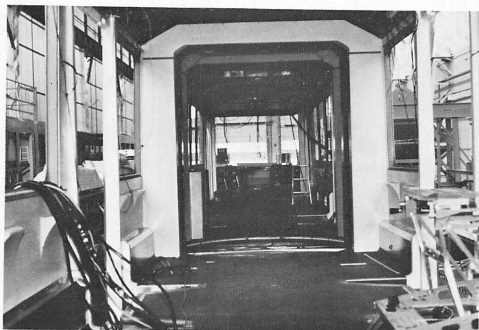
2 vues intérieures des motrices articulées 6000 pour la SNCV en cours de construction. Ci-dessus vue vers le poste de conduite. Ci-dessous vue vers l'articulation. (Photo W. Hoste)
