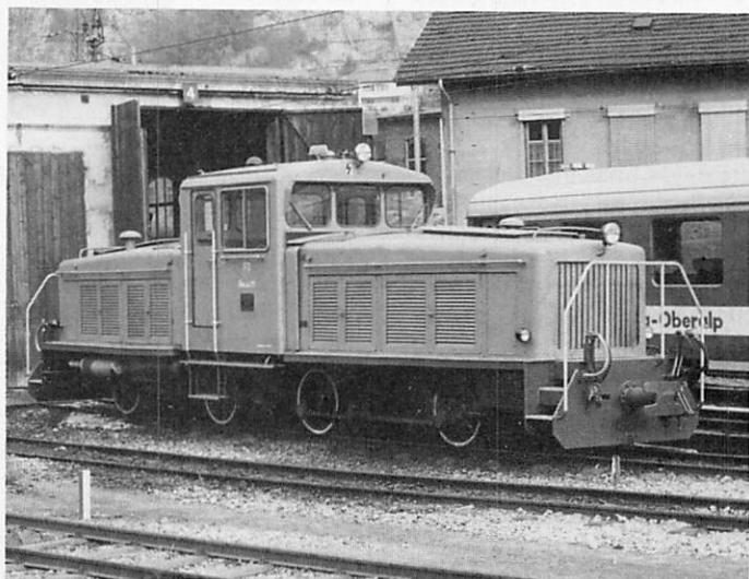
1,58 m de large. L'appareillage électrique se dresse à l'intérieur du véhicule, de part et d'autre d'un couloir mettant en communication les postes de conduite et le compartiment central à bagages. Le transformateur principal est disposé sous la caisse, vers le milieu du véhicule. Quant au toit, il supporte les résistances de freinage et les deux pantographes unijambistes.
