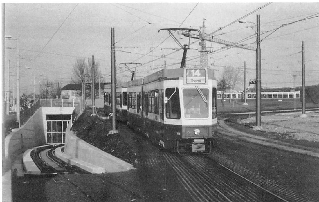
ZURICH - MILCHBUCK (30 décembre 1983). Un tram "2000" de la ligne 14 vers Triemli longe la rampe de sortie du tunnel de Schwammendingen (Photo Dieudonné)
