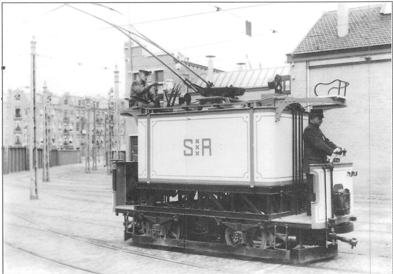
Nogmaals de sproeiwagen op het voorterrein van de remise Tollensstraat een jaar later. Ditmaal zijn de grijze sierlijnen en de koplamp aangebracht. De letters "SR" zijn donkergrijs geworden. Heel duidelijk zichtbaar is de werkplek van de "sproeibaas" bovenop de tank vlak onder de beugel. (foto archief Gemeentetram, verzameling H.J.A. Duparc)
