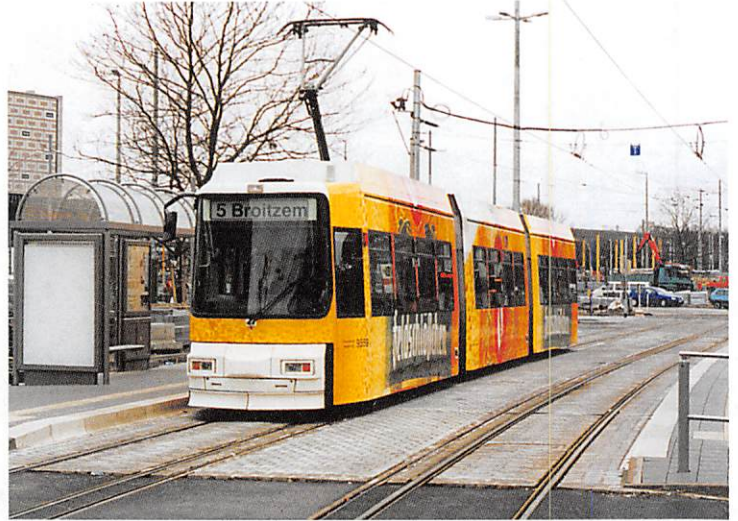
Braunschweig Bij het vernieuwen van sporen wordt systematisch het 1100 mm spoor aangevuld met een derde rail, zodat in de (verre ?) toekomst zal kunnen worden overgegaan op normaalspoor (1435 mm). Hauptbahnhof, 16 maart 2000. (foto Jaap van der Noordt)
