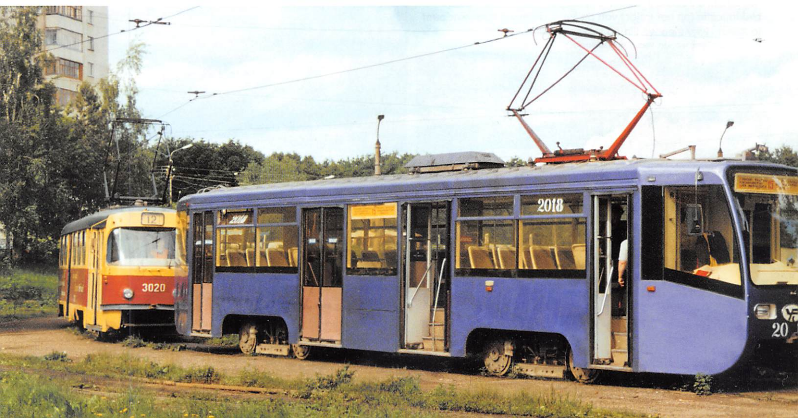
Aan het eindpunt Strotelnaya in Ufa staat op 1 juni 2001 de laatste aanwinst en voorlopige eenling te wachten op zijn vertrektijd. Het gaat hier overigens om een KTM-19K, waarbij andere deuren gebruikt werden. (foto Alex Krakowsky)
