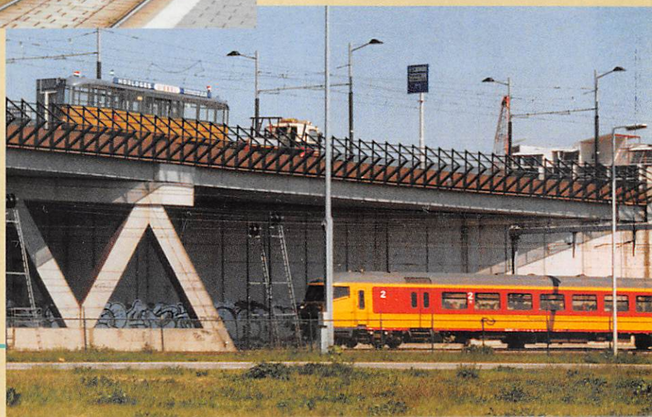
Links. Vierasser 537 rijdt tijdens een proefrit met de beugel voorop, wat sinds 1989 niet meer toegelaten was i.v.m. de bovenleidingscontacten en het ontspringsgevaar voor voorgangers. Inmiddels worden bijna alle wissels elektronisch gestuurd, zodat dit niet zo'n probleem meer vormt ! Rotterdam-Zuid, Randweg, 27 juni 2001. (foto Theo Barten)
