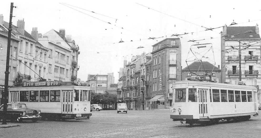
Schaarbeek, Daillyplein. Hier ontmoet een tram van lijn B uit Leuven de Brusselse stadslijn 60. Bemerkt de wissel en het derde spoor dat gebruikt werd door de stoomtrams en spoorauto's vanuit Geldenaken of Tienen (via Hamme-Mille en Vossem) 24 juli 1960. (foto Robert Temmerman)
