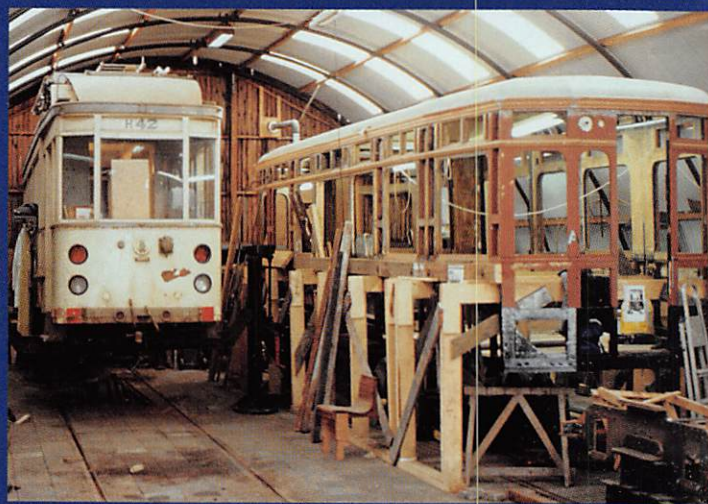
Het interieur van het "huisje van Beesd" is hier nog zichtbaar. De ontbrekende zijwand werd geleverd door de resterende bak van de B306. (foto Peter Kalse)
