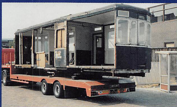
Het interieur van het "huisje van Beesd" is hier nog zichtbaar. De ontbrekende zijwand werd geleverd door de resterende bak van de B306. (foto Peter Kalse)
