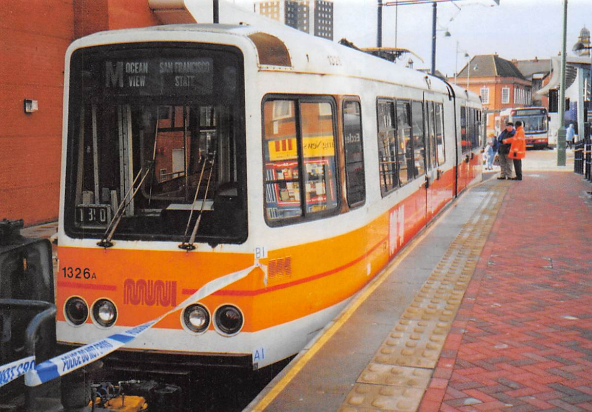
Eerste ruimteprofieltest met ex-MUNI 1326, aan het eindpunt Eccles te Manchester, op 5 februari 2002. Men merkt duidelijk dat het openen van de deuren niet zonder problemen zal verlopen ! (foto Graham Brittain)
