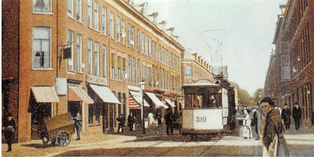
Een aantal paardentramrijtuigen werden geschikt gemaakt voor de elektrische dienst. Bijwagen 319 is een voormalige paardentram die in 1880 te Brussel werd gebouwd. (verz. Karel Hoorn)
