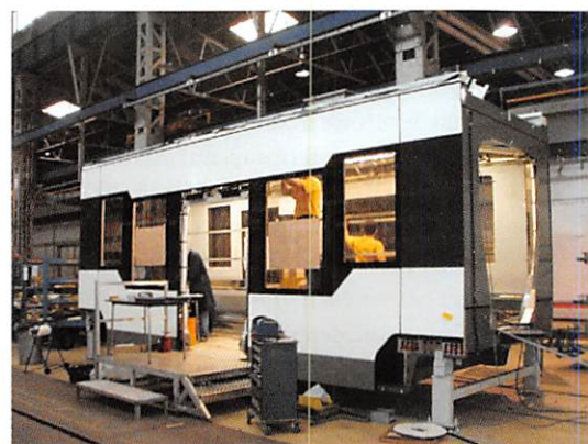
Bouw van de eerste tussenkast van de tweede generatie in de fabriek van Bombardier Transportation te Brugge. (foto Eddy Geuvels)
