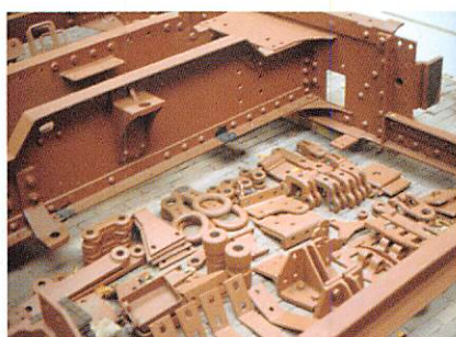
Bij het revisieprogramma van de RET-draaistellen worden deze tot het laatste onderdeel uiteen genomen en gereviseerd.
