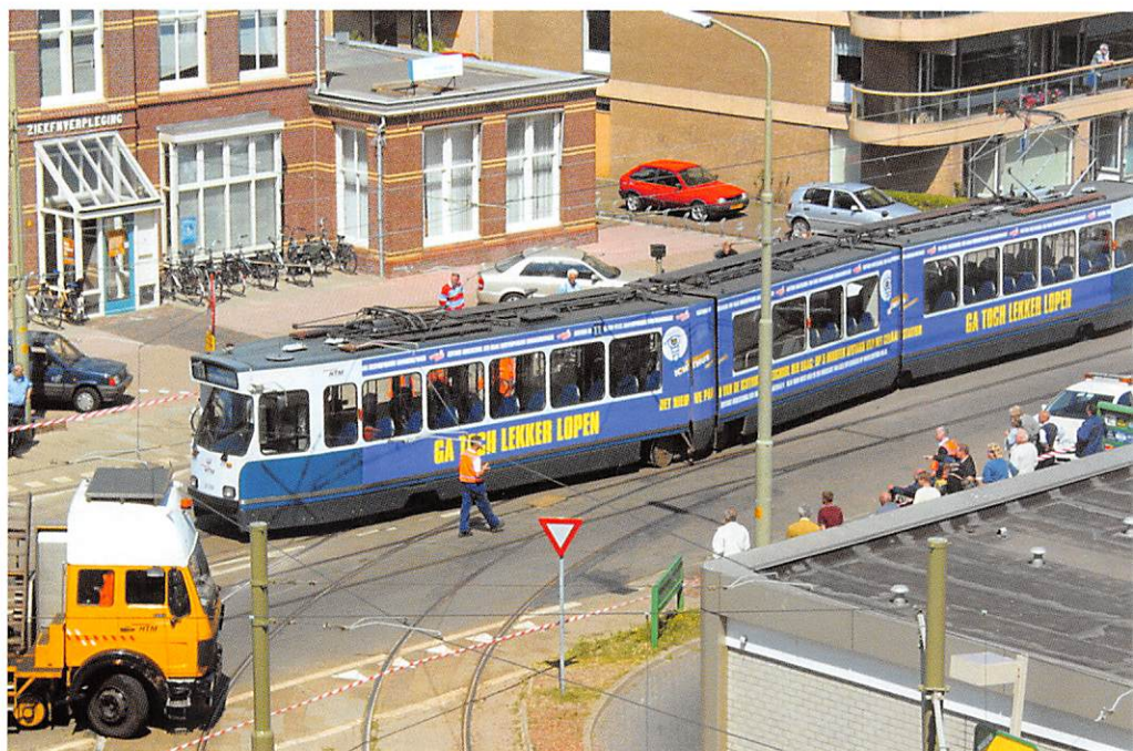
Op het uitrukspoor vanuit de remise Scheveningen in de Duinstraat ontspoorde op 27 juni de 3129. De tram was op weg naar lijn 11. Met een opgelaten achterste pantograaf kon deze GTL-8-II door achteruitrijden terug in het spoor worden gezet. (foto Kees Verhulst)
