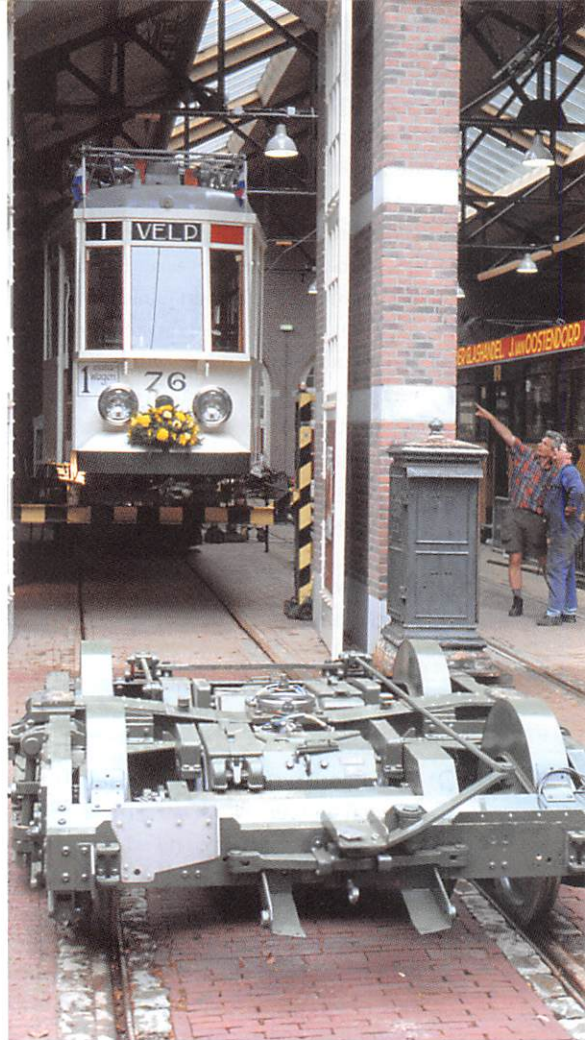
De draaistellen zijn gereed gekomen en worden hier onder de bak van de 76 gereden. Vergelijk het draaistel op deze foto eens met de zwart/wit foto van het originele draaistel uit 1928.
