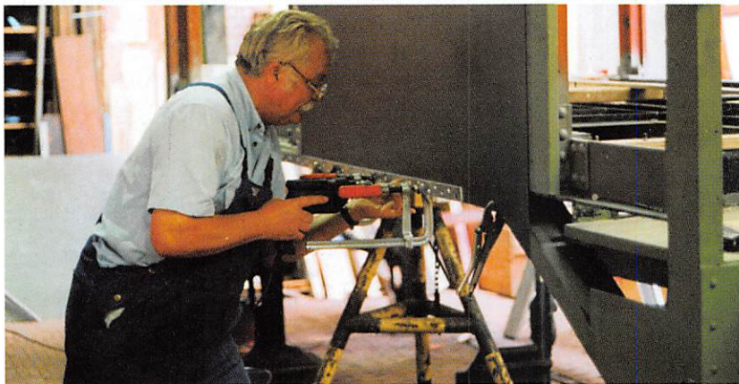
De eerste beplating wordt door 'remisechef' Hans van den Ham weer aangebracht op het vernieuwde frame van de wagenbak van de RET 535, begin juli 2002.
