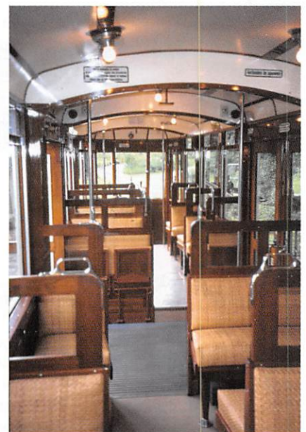
Met veel aandacht voor detail werd met behulp van foto's het originele interieur van de 76 nagebouwd. Let ook op de klapstoeltjes op de balkons.
