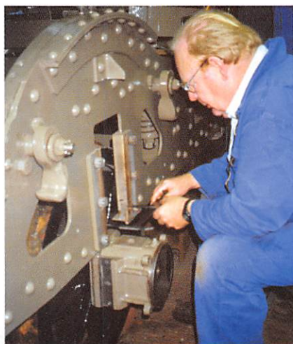
Een laatste controle door Alex Pak voordat de truck wordt teruggeplaatst op de aspotten.
