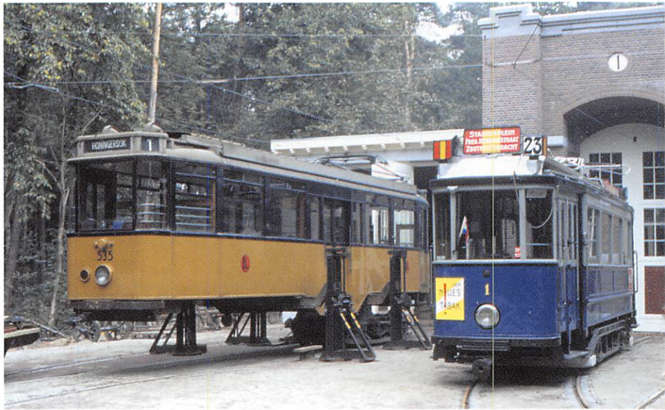
In de wintermaanden van 1996-97 werd wagen 535 gereviseerd, waarbij de draaistellen tijdelijk werden verwijderd. Hier staat de wagen opgebokt naast de gast zijde "Utrechtenaar" 1 uit Amsterdam.
