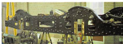
De totaal ontmantelde truck van de Haagse 274 tijdens de grote revisie.
