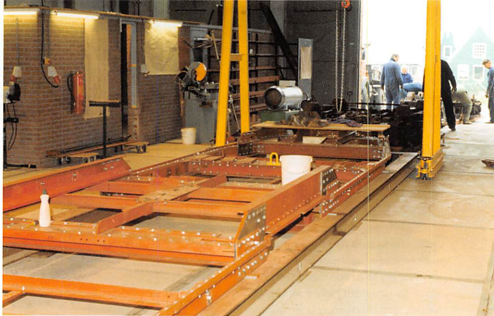
Constructie van het bodemframe voor de GETA 76, in de Landbouwwerktuigenloods "Goes", gelegen in het Openluchtmuseum.
