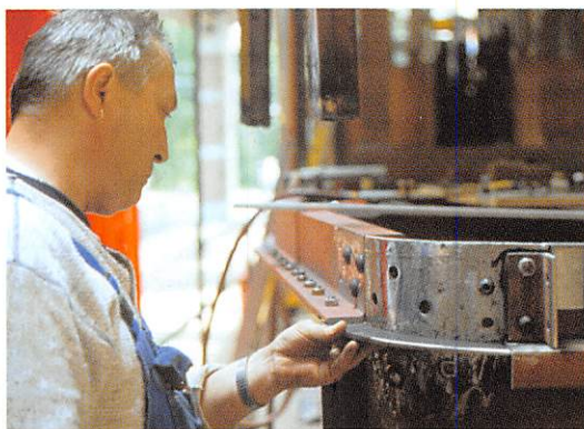
De eerste beplating wordt door 'remisechef' Hans van den Ham weer aangebracht op het vernieuwde frame van de wagenbak van de RET 535, begin juli 2002.
