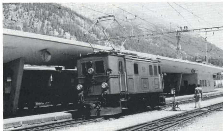
PHOTO 20-12 La Ge 2/4 221 des RhB, affectée aux manoeuvres à Samedan, a été retirée du service cet été. Cette petite locomotive, construite par SLM, fut mise en service en...1913! (numérotée alors Ge 2/4 203). Son unique moteur monophasé, d'une puissance de 428 kW, était relié par bielles à un faux-essieu, qui transmettait le mouvement aux essieux moteurs à l'aide de bielles motrices. 27 juin 1984. Photo : J-L VDH
