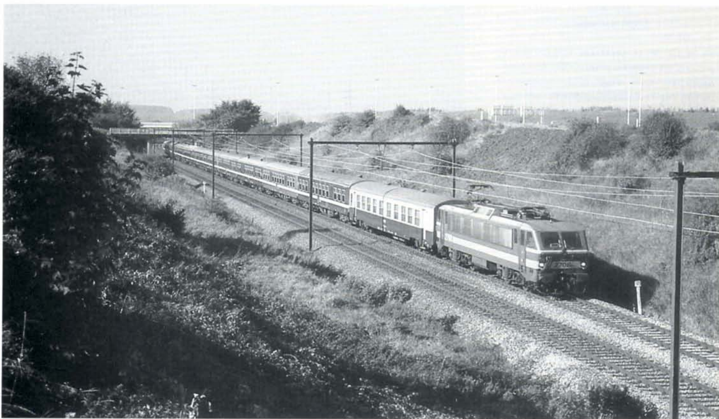
Depuis le 2 octobre, une voiture USI de la SNCF (n° 50-87-2074 787-4), identique aux 84 voitures rachetées par la SNCB, est incorporée, dans le but de procéder à l'essai de blocs de frein, dans une rame M4 effectuant la relation Oostende - Eupen et Oostende - Leuven. Cette voiture est ici visible derrière la locomotive de l'IC 509 Oostende - Eupen. Anderlecht, 15 octobre 1994. Photo : Christian DOSOGNE.
