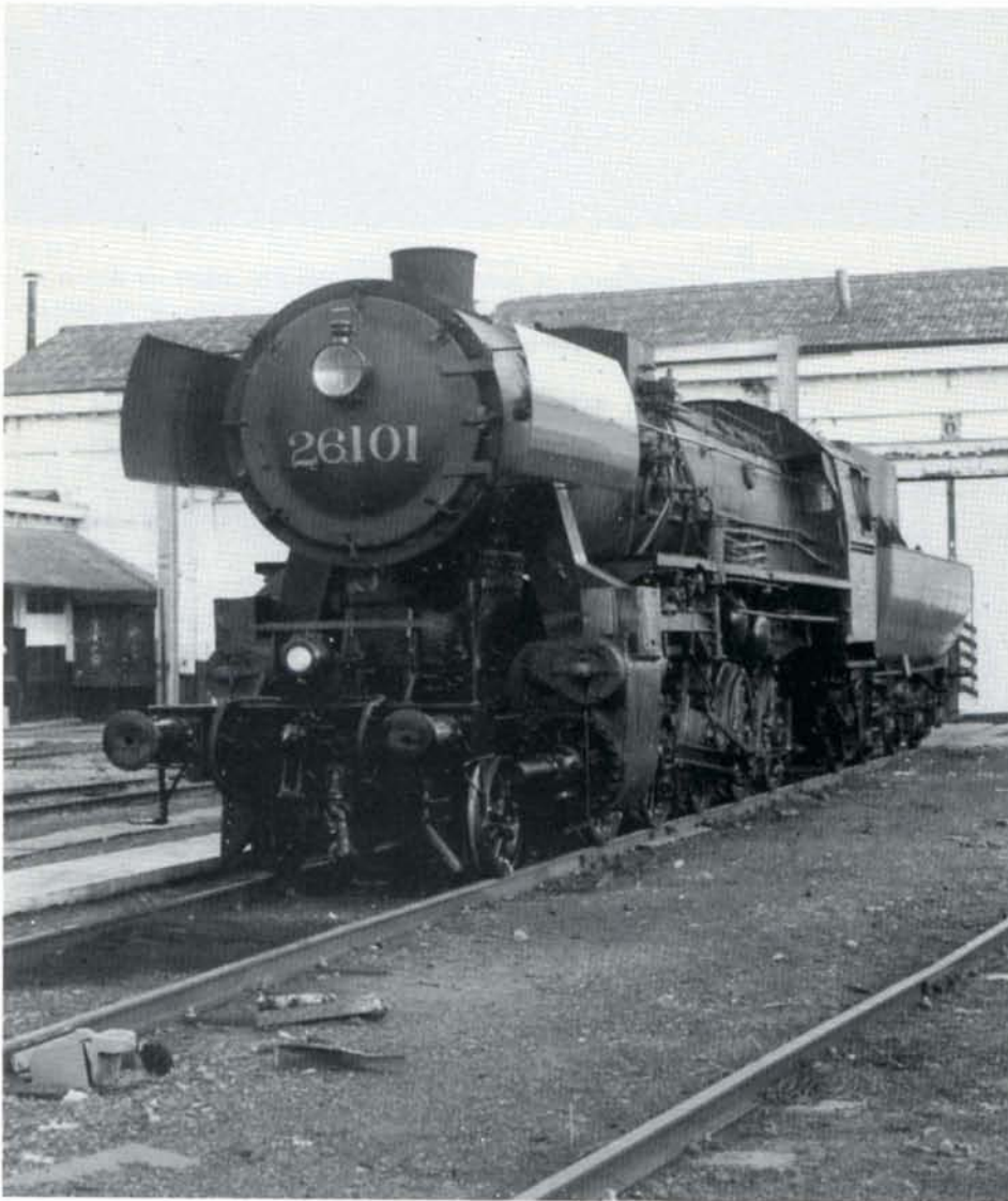
PHOTO 20-10 A Mons, la 26.101 fut mise - l'instant d'une photo - à simple phare, la rendant ainsi pratiquement identique aux types 26 de la SNCB. La circulation avec un feu unique n'est pas tolérée par la réglementation de la SNCB, ce qui explique la présence des deux phares blancs lors des circulations.
