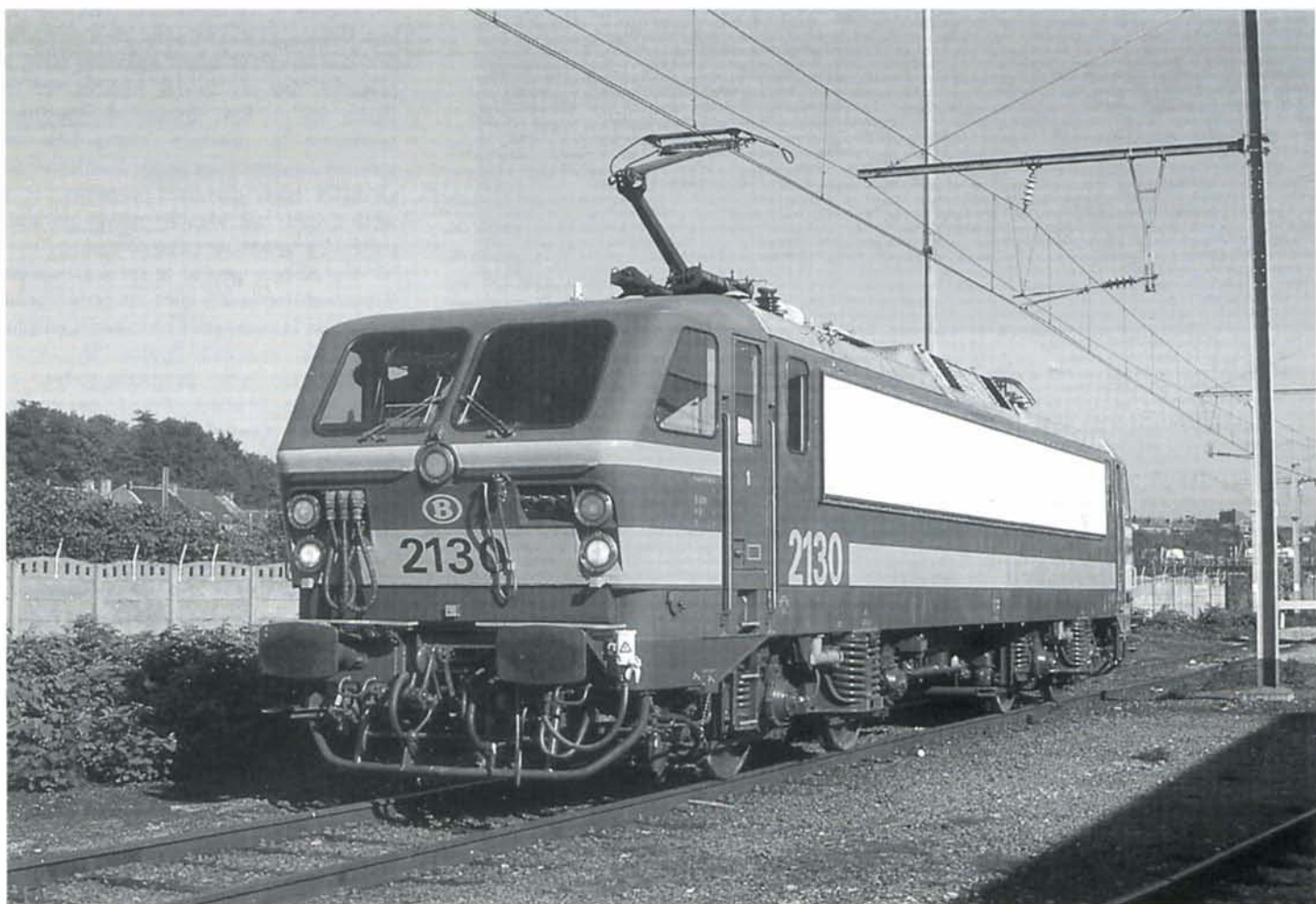
La 2130 après transformation en machine bitension 3kV/25kV à moteurs asynchrones triphasés. C'est le panto n° 1 Brecknell & Willis, pour le 25kV, qui est levé. AC-Salzinnes, 12 octobre 1994.
