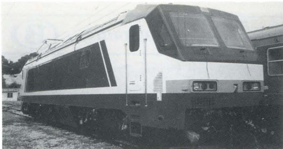
La E402.007 des FS, non encore pourvue de ses numéros, photographiée à Caserta le 15 juin 1984. Par rapport aux prototypes, on note la forme entièrement différente et futuriste des cabines de conduite, ainsi que la livrée rouge et blanche. Photo : FIREMA.
