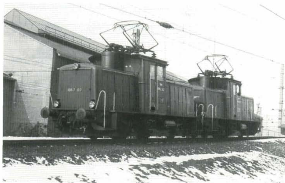
Les 1067.02 et 03 en UM sur la butte de triage de Salzburg Gnigl en mars 1980. Les deux machines totalisaient 930 kW pour une configuration C+C. A titre de comparaison, une 1063 fournit 1000 kW en configuration Bo'Bo'.
