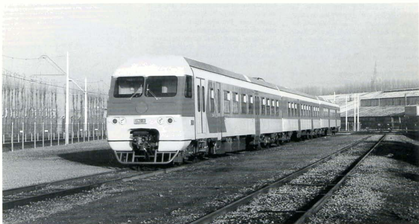
Les automotrices de la nouvelle série ne se différencient des premières que par leur équipement d'air climatisé et l'absence des deux petits feux blancs au-dessus des pare-brise. L'automotrice ZRC-11 est vue à Brugge, le 30 novembre 1994.
