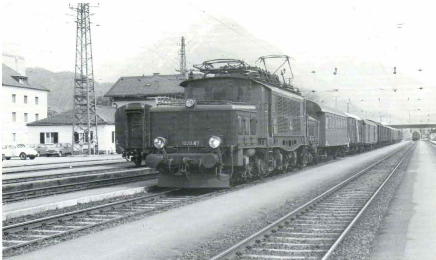
PHOTO 22-02 Les 1020.45 à 47 autrichiennes furent construites en 1953 à partir des éléments récupérés des 5 E94 non achevées en 1945, notamment à la Wiener Lokomotivfabrik. Ici, la 1020.47 (WLF 17.689/1953 et AEG) dotée de gros phares accentuant son allure impressionnante, photographiée à Bludenz le 28 avril 1982. Cette machine fut réceptionnée le 14 septembre 1954 au dépôt de Salzburg, et radiée le 20 septembre 1984 à Bludenz. Elle fut toutefois remise en service en 1986 à l'occasion des 150 ans des chemins de fer en Autriche. Photo : Jean-Luc VANDERHAEGEN.
