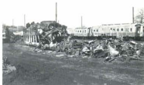
PHOTO 22-15 ⊗ Quelques heures plus tard, après le passage des vautours, il ne restera plus que de la ferraille, laquelle sera triée (fer, aluminium, cuivre,...) et ensuite envoyée dans une aciérie où elle sera enfournée dans un convertisseur.
