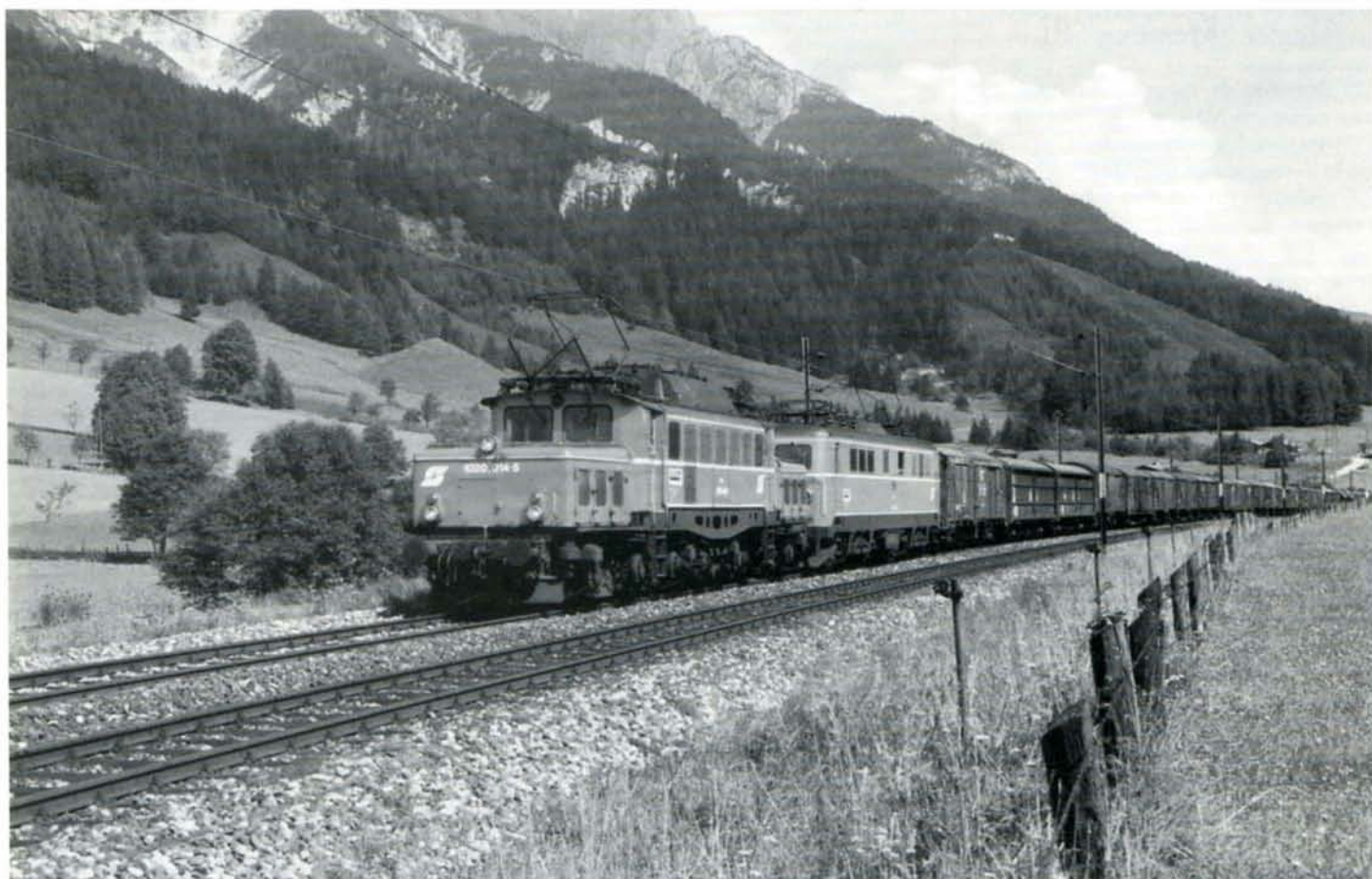
PHOTO 22-03 La 1020.014-5 allège une locomotive de la série 1010 entre Saalfelden et Wörgl (ligne Salzburg - Zell-am-See - Innsbruck). Cette machine, ex. E 94.129, fut construite par Krauss-Maffei (n° 16.013) et SSW en 1944, livrée à la DRG le 15 avril 1944 et réceptionnée au dépôt de Salzburg le 24 avril 1944. Ce document la montre dans sa version modernisée (pare-brise, phares, grillages d'aération et la nouvelle livrée rouge). Elle fut retirée du service le 1er juillet 1994 au dépôt de Wörgl.
