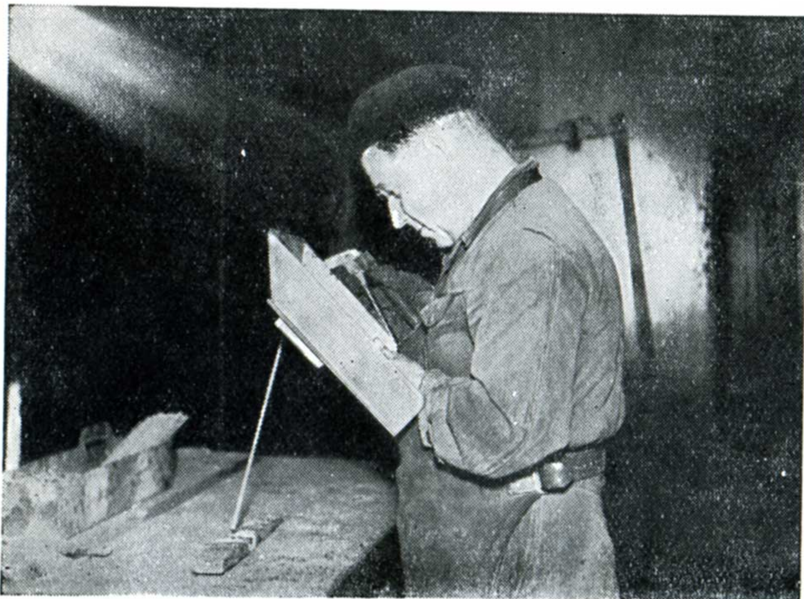
Soudure à l'arc électrique en cabine avec écran de protection.
