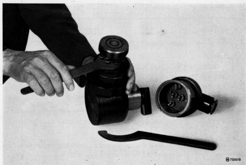
Fig. 8 - Dévissage du collecteur.
