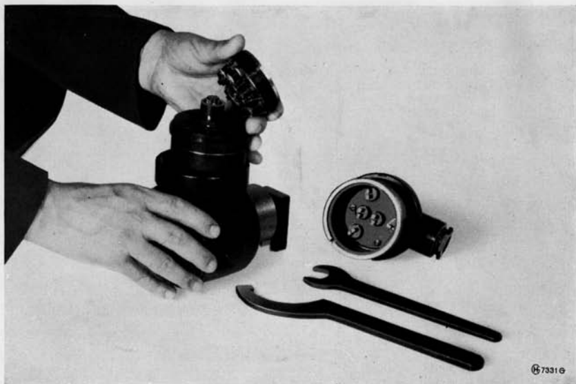
Fig. 9 - Démontage du collecteur.
