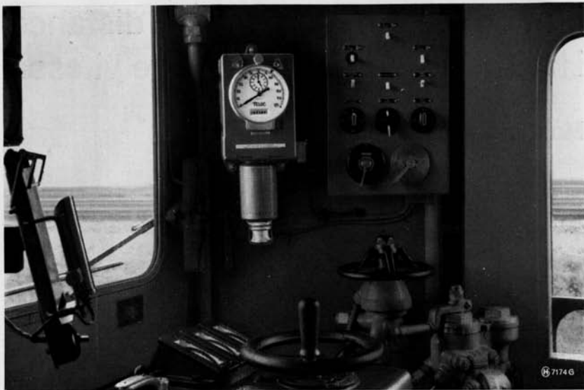
Fig. 2 - Tachygraphe TELOC RT 935 avec entrainement par commande électrique à distance Hasler, monté dans un poste de commande de locomotrice.
