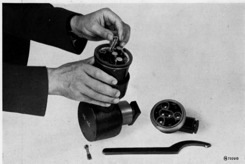
Fig. 7 - Contrôle des charbons 5.8311.109.
