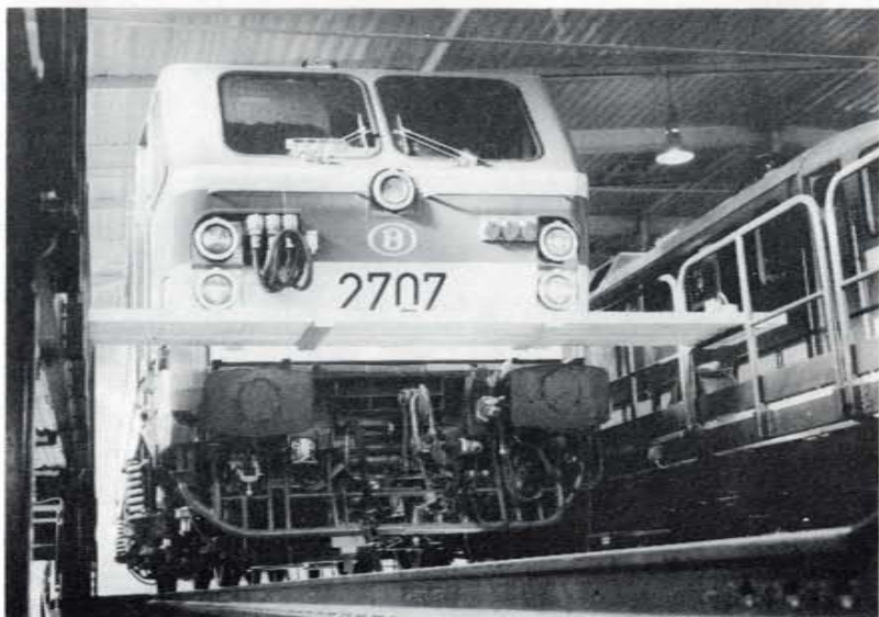
De spoorstaafruimer, de koppeling, de slangen en de verbindingkabels zijn zojuist geplaatst.
