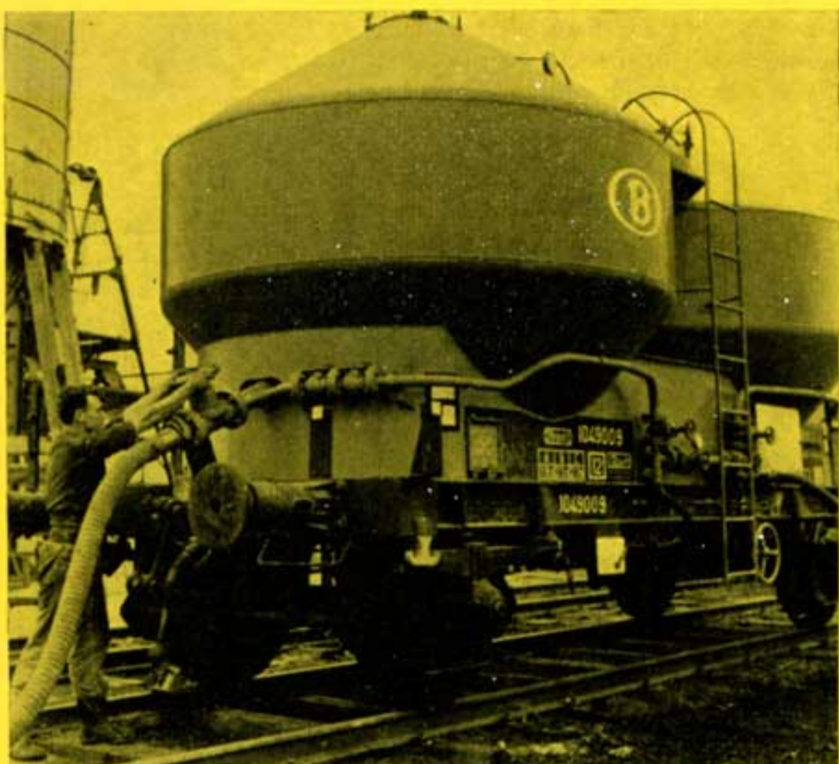
La vanne d'évacuation du ciment est ouverte.
