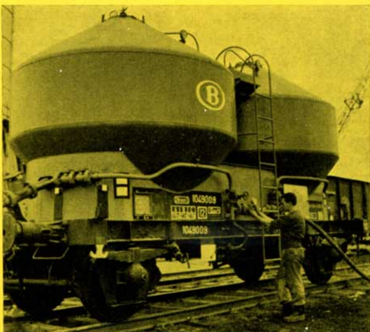
La vanne d'admission de l'air comprimé est ouverte et la citerne mise ainsi sous pression.
