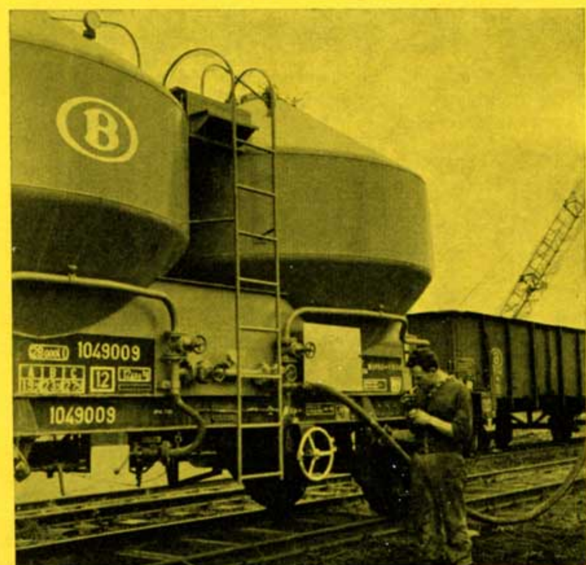
La vidange du wagon se fait automatiquement.
