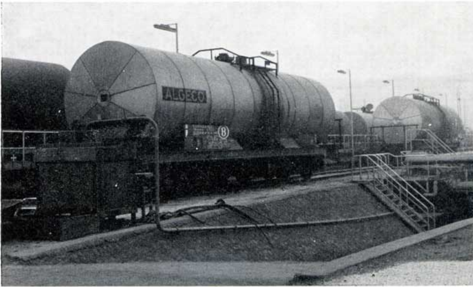
Wagon-citerne calorifugé en cours de déchargement à l'ARBED-usines de Belval.
