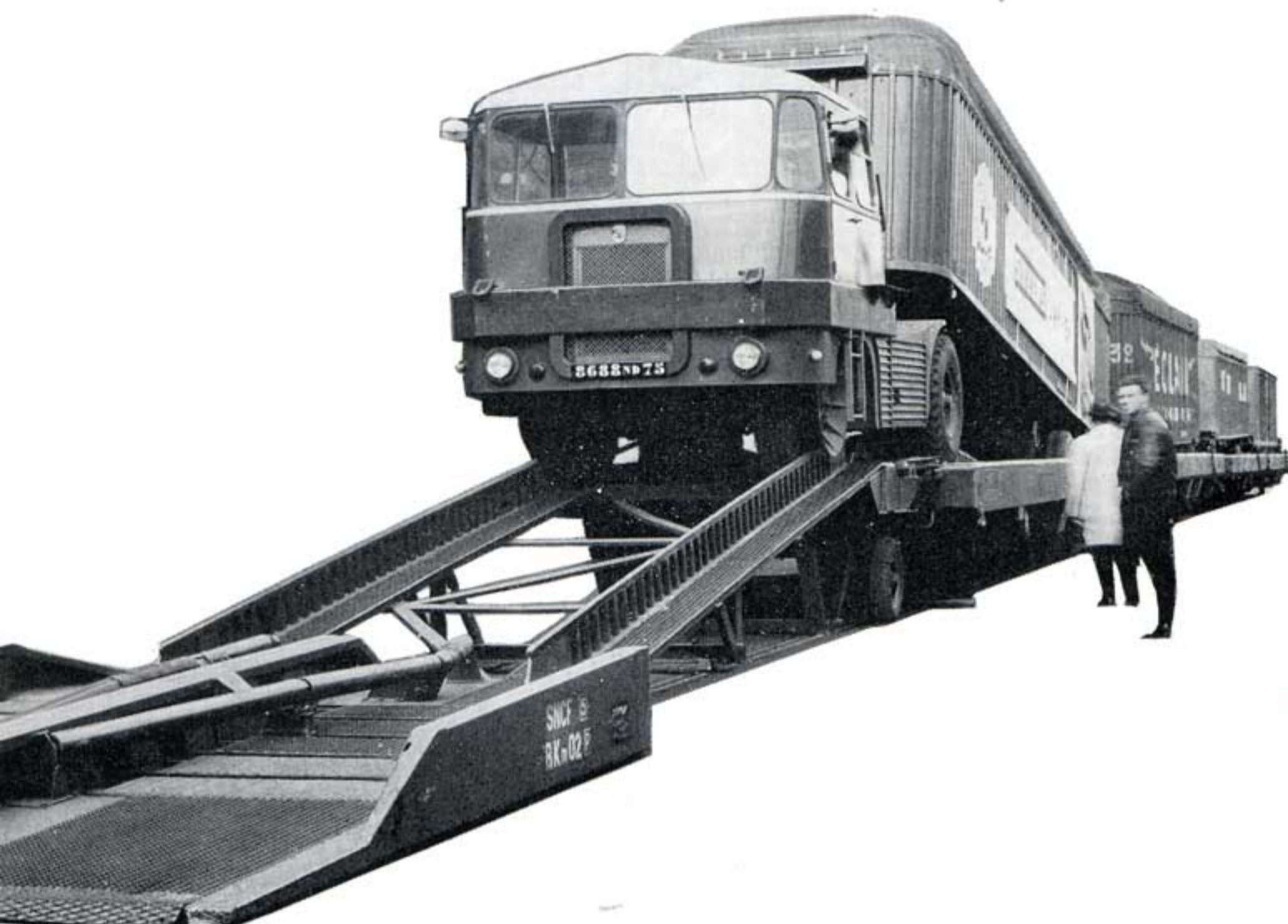
▲ Figure a. Le système « Kangourou ». Rails de guidage en position haute (à gauche), en position basse (à droite).
