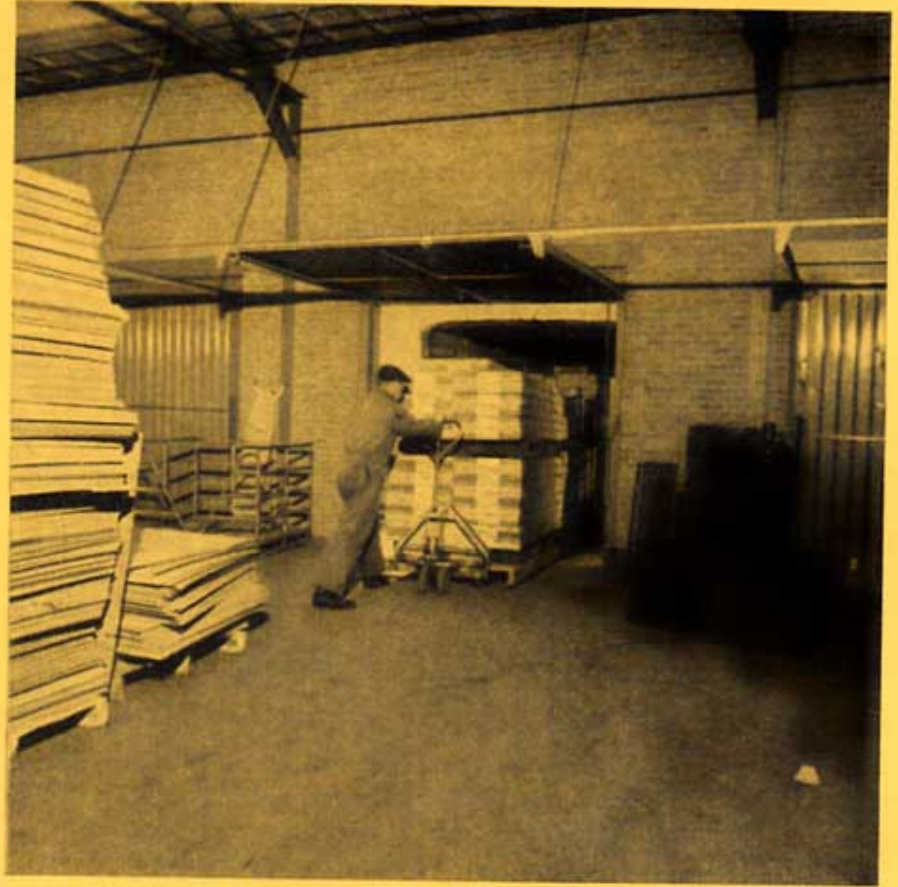
De beladen pallets worden in de camion gereden door middel van een handhefwagen.
