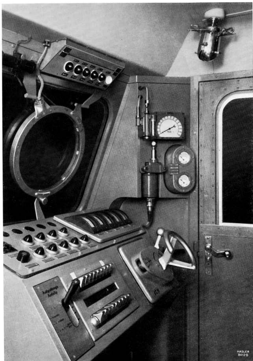
Fig. 10. - Tachymètre TELOC A 620 (exécution spéciale) avec commande électrique à distance, monté dans une cabine d'une locomotive électrique B.B. type 122 de la Société Nationale des Chemins de fer belges (SNCB)
