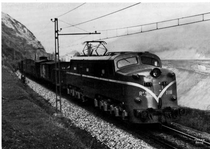
Fig. 5. - Locomotive électrique à courant continu du Chemin de fer d'Etat espagnol (RENFE) munie de tachygraphes TELOC RT 220
