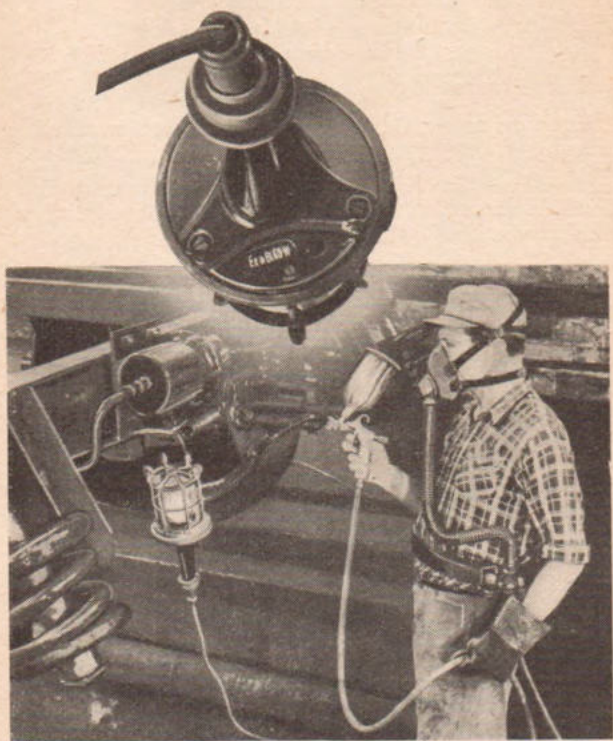
Hier wird mit einer solchen explosionsgeschützten Leuchte gearbeitet!
