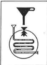
Raccord de remplissage pour combustible de la chaudière.
