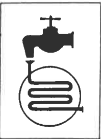
Raccord de remplissage pour l'eau de la chaudière.
