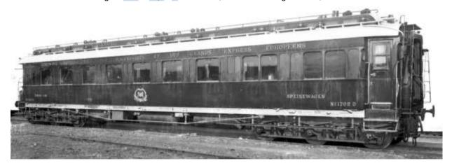
Insgesamt ist die sechsachsige Bauart durchaus geschichtlich interessant, versuchte doch die CIWL seinerzeit mit diesen Waggons, die Laufruhe bei höheren Geschwindigkeiten mit dieser Drehgestellbauart zu erhöhen [1].
