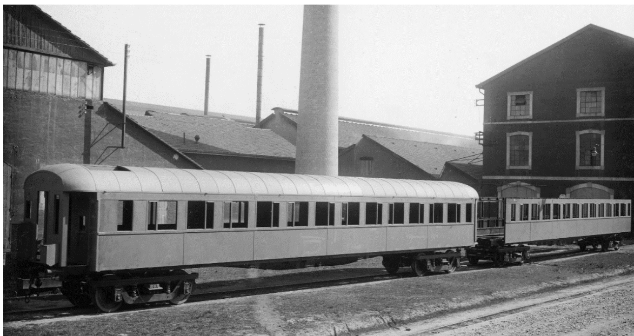
(13) Confronto tra la vettura con i vestiboli rimontati e un'altra in fase d'allestimento sui binari esterni dello stabilimento 32 .
