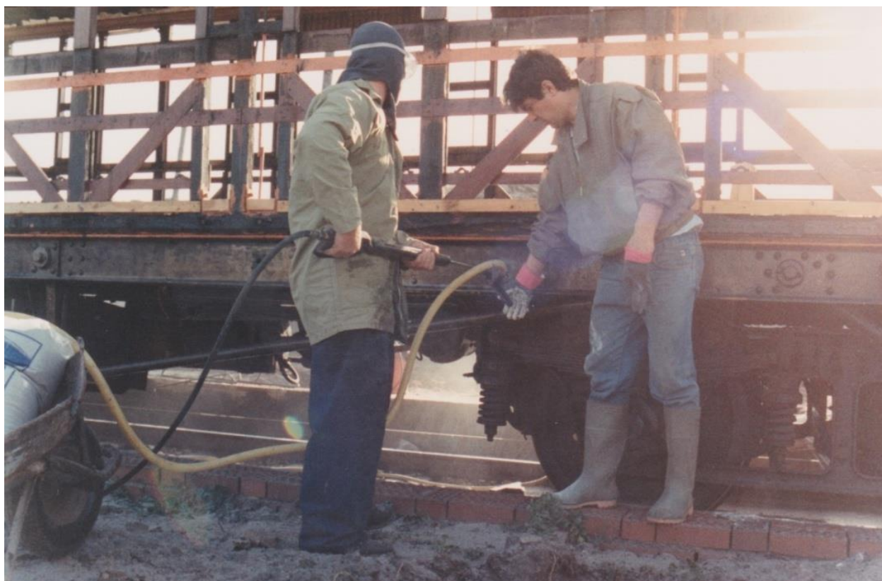
Tras la operación de granallado del bastidor, se pudieron ver distintas capas de pintura que sirvieron como cata para aplicar el color del bastidor más acorde a su estado original. Fotos cedidas por sus propietarios.
