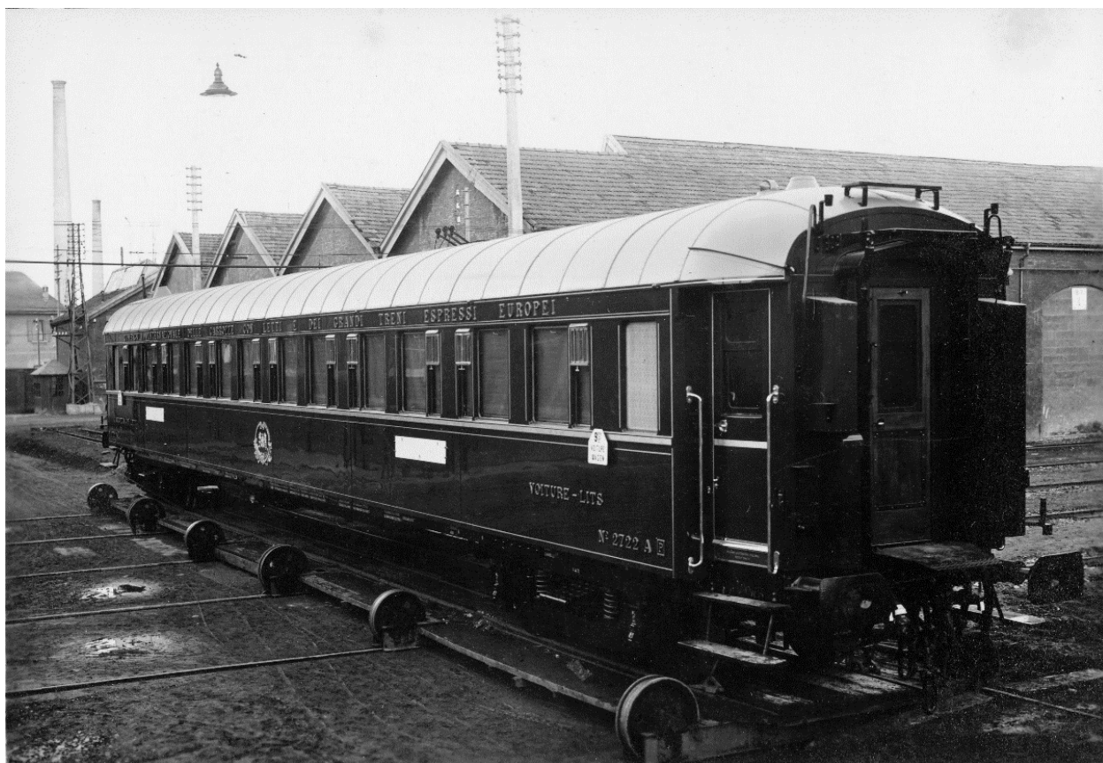
(14) La carrozza-letti WL Z 2722 appena consegnata dalle Officine Meccaniche Italiane di Reggio Emilia fa bella mostra di sé sul carrello trasbordatore 33 . Possiamo notare i numeri e le scritte in rilievo.
