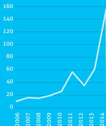
**Exemple** > évolution de la consommation d'eau dans un faisceau d'un poste d'entretien : constat d'une fuite importante et réparation.
