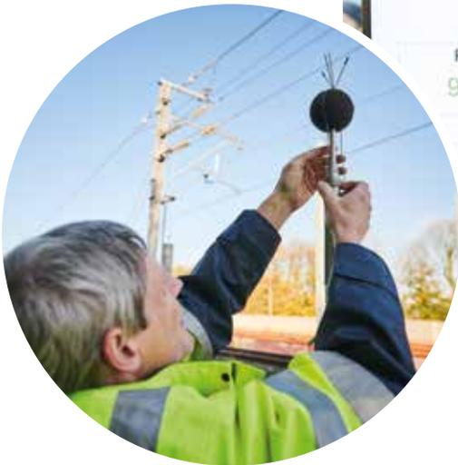
Installation d'un microphone utilisé pour mesurer le bruit.
