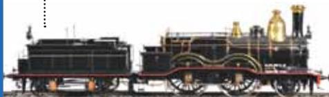
Après la guerre, les apprentis passaient pas moins de 24 heures par semaine à construire ces répliques quasi parfaites du matériel roulant de l'époque et du passé. Ce travail leur permettait d'apprendre les mécanismes de fonctionnement du matériel roulant, la soudure, à être minutieux, etc. L'objectif était également de garder une trace du passé. Les meilleures maquettes étaient récompensées chaque année dans le cadre d'un concours.
