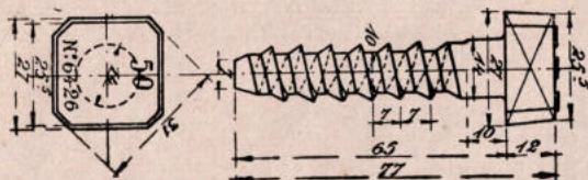
Fig. 16. — Schroefbout voor schuiflat. (Halve grootte).
