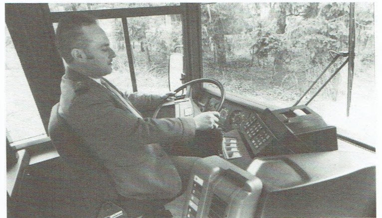
De stuurpost is ergonomisch ingericht. De stoel en het stuur zijn regelbaar; zelfs aan de stand van de pedalen werd een speciale studie gewijd. De magnetische ontwaarder — vooraan op de foto — bevindt zich dichtbij de chauffeur. (Foto : Marc Deville)
