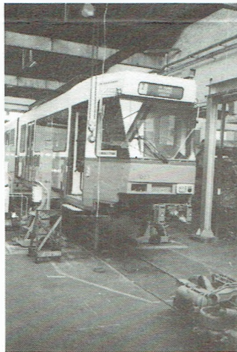
Het lichten van een rijtuig gebeurt door een heftoestel. Rechts onderaan kan je een draaistel, dat van de kas werd losgemaakt, zien. (Foto: Danny Taelmans)
