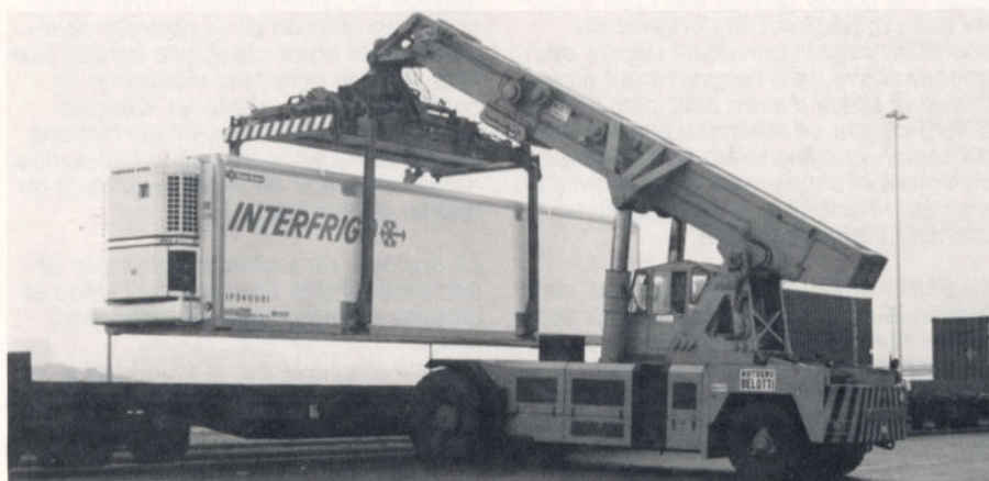
▲ La caisse mobile en cours de chargement
