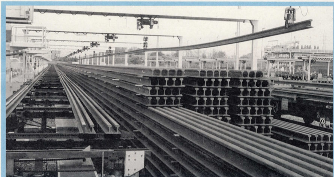
Tout au nord de Schaerbeek, notre atelier central Infrastructure produit des rails de 300 m de long
