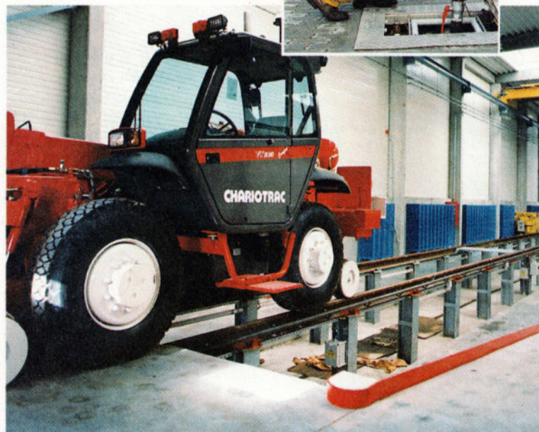
Un locotracteur déplace les voitures dans le hall. Il roule sur la voie surélevée de 90 cm. L'espace est bien dégagé pour les travailleurs.
