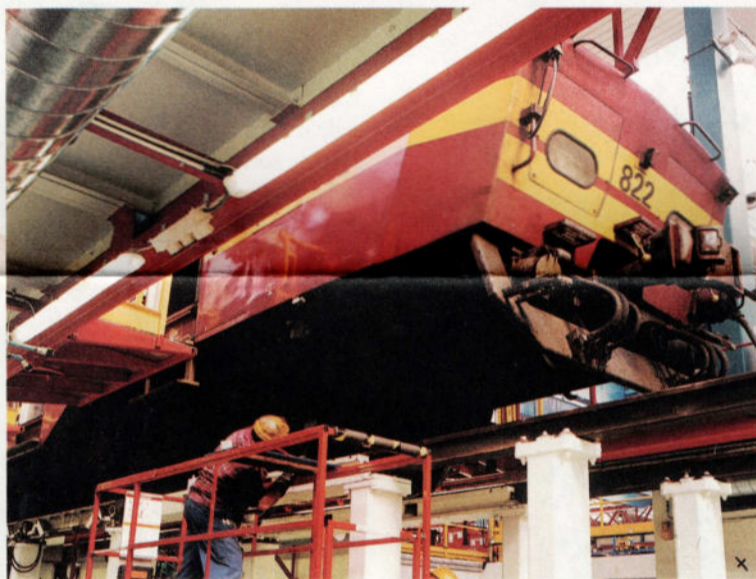
Dans l'atelier de Charleroi, l'on remplace les essieux avariés suivant la technologie des rails éclipsables.
