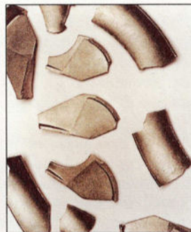
Ces quelques morceaux sont ce qui reste d'une poulie servant à la fois de ventilateur et de frein au palan d'un pont roulant de 8 tonnes. Lors d'un test du système d'arrêt d'urgence, la poulie a littéralement explosé et le bloc de béton de 8 tonnes utilisé pour l'essai est brutalement tombé de 6 mètres.
