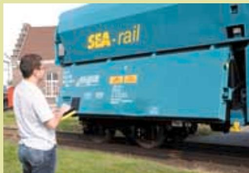
La commande à distance permet une ouverture facile des wagons à décharger
