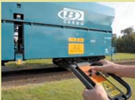
wagons ne vont pas seulement être équipés des systèmes d'ouverture hydrauliques créés il y a quelques années par Gentbrugge pour d'autres wagons, de type 6006 B 0, spécialisés dans le transport de zinc. Ils seront également munis d'équipements électroniques avec commande à distance très faciles à utiliser. Au total 150 wagons vont être progressivement équipés du système.
