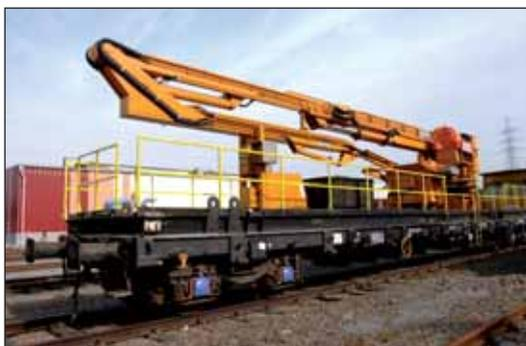
A côté des voies et des ouvrages d'art, Infrabel entretient également la caténaire. Pour cet entretien et les réparations, les équipes techniques peuvent utiliser les autorails du type ES 500. Ces machines sont équipées d'une grue et d'une plateforme hydraulique réglable en hauteur qui peut tourner à 90° à gauche et à droite.
