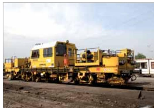
Le trafic intense a tendance à déformer les voies. L'EMV 98 B doit donc de temps en temps les niveler. Concrètement, l'engin soulève la voie et la redépose au bon endroit. Dans le même temps, si nécessaire, l'EMV insère du ballast sous les traverses. Mais cette machine offre encore d'autres fonctionnalités. Outre le bourrage, elle peut aussi être utilisée comme régaleuse et peut même tracter un wagon.
