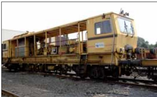
Infrabel possède également quelques machines très spécialisées, comme l'élévateur à nacelles Comet. Cette machine est employée pour le contrôle de la structure des ponts difficilement accessibles depuis le sol, comme le viaduc de Moresnet, par exemple.
