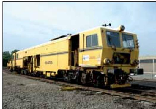
La bourreuse 108-475 S est unique en Belgique. Avec cette machine, Infrabel bourre de grands modèles d'appareils de voie. Cette bourreuse peut également être utilisée sur les lignes à grande vitesse puisqu'elle est équipée du système TVM430. Une fois le ballast renouvelé, la voie n'y est pas encore ancrée suffisamment fort. Voilà pourquoi le stabilisateur DGS62N doit faire vibrer la voie et
