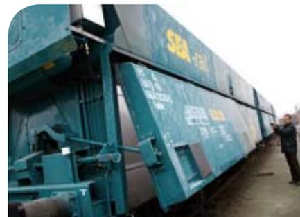
Le chef de projet Axel De Dobbeleer fait la démonstration du système de télécommande de l'ouverture des portes de déchargement.
